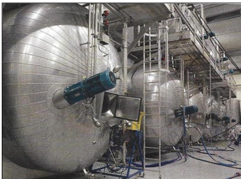
Slika 11. Izobarična, ležeča cisterna velikosti 600 hl, v njej poteka sekundarna alkoholna fermentacija in zorenje na kvasovkah. Ležeča oblika cisterne pospešuje optimalni stik kvasovk z vinom. Termoregulacija je zagotovljena s 30 cm debelo plastjo steklene volne, skrito za zunanjo kovinsko lupino (Marchal, 2023, str. 40)
